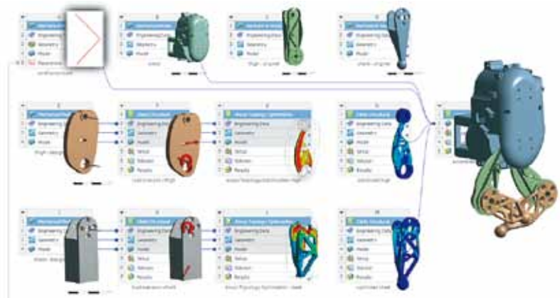
图 5 机器人手臂增材正向设计 --- 流程与演进
