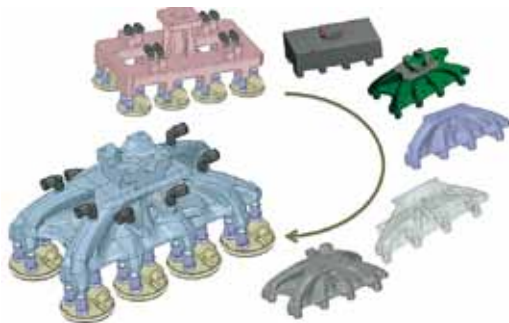
图 7 分流器封盖增材正向设计 --- 流程与演进
